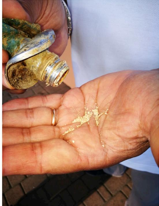
In un rubinetto sostituito è evidente la quantità di calcare presente, completamente disaggregata
